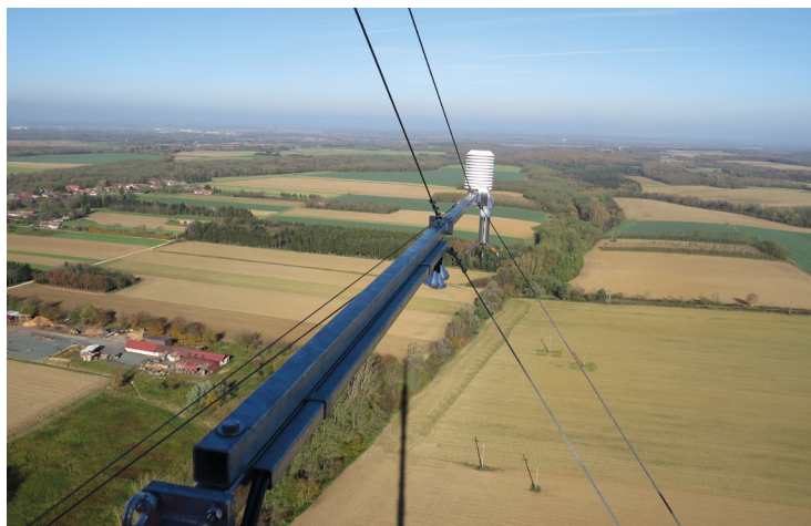
2. fénykép. Meteorológiai érzékelők és levegőbeszívó csövek 115 m magasban.
